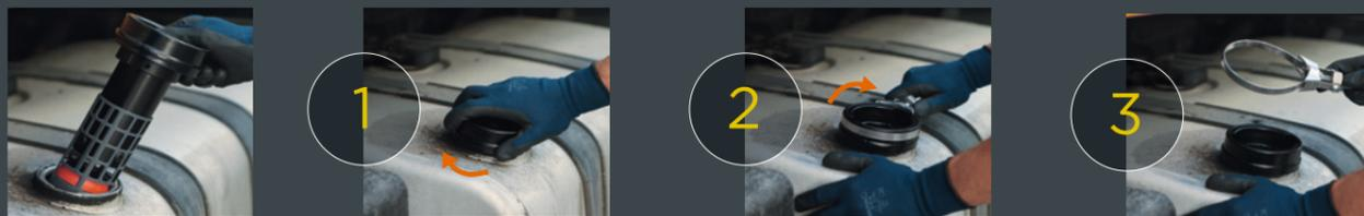
Installazione molto semplice e veloce: Kockòn si installa facilmente attraverso un semplice sistema brevettato che prevede solo l'inserimento e la rotazione del dispositivo fino al suo bloccaggio:
