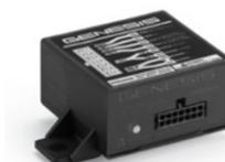
Collegato a ZIPPER WIRELESS ed equipaggiato con una SIM M2M, può essere programmato per inviare un SMS di avvertimento al numero di cellulare programmato, indicando che il serbatoio è stato aperto, in tempo reale.
